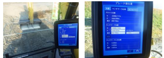
作業装置の整合確認（画像提供：湯澤工業(株)）
