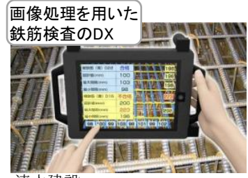
清水建設・ リアルタイム自動配筋検査システム
