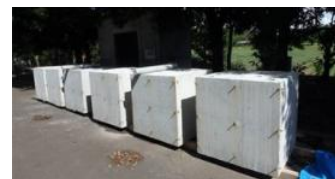
ゼネコン13社共同・ CELBIC(環境配慮型BFコンクリート)
