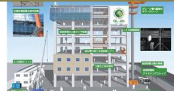
戸田建設・TO-MINICA(低炭素施工システム)
