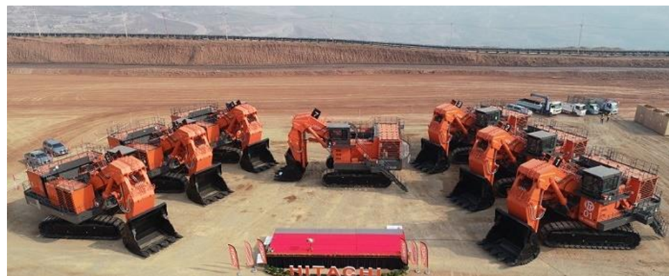
日立建機・EX3600E-6LD (タイ建設企業に納入した電動式油圧ショベル)
