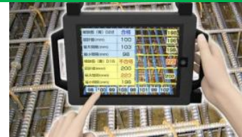
清水建設・リアルタイム自動配筋検査システム
