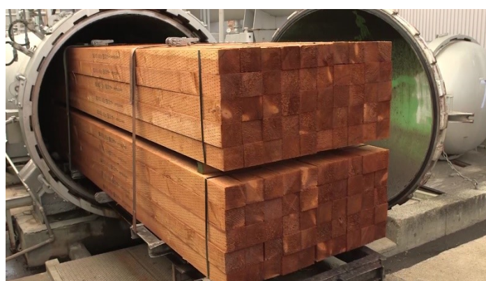
写真 1.3.1 薬剤を加圧処理する注薬缶
