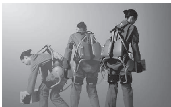
AWN-03Bは体幹の動きに合わせて荷役作業時の腰への負担を軽減する。
