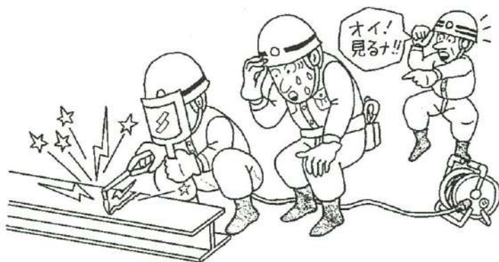
保護具をせずに溶接作業を直接見ると目を痛めることを知らない
