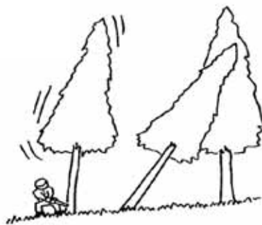
図4 かかり木に激突させるためにかかり木以外の立木を伐倒
