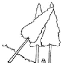
(図3)かかっている立木の伐倒
